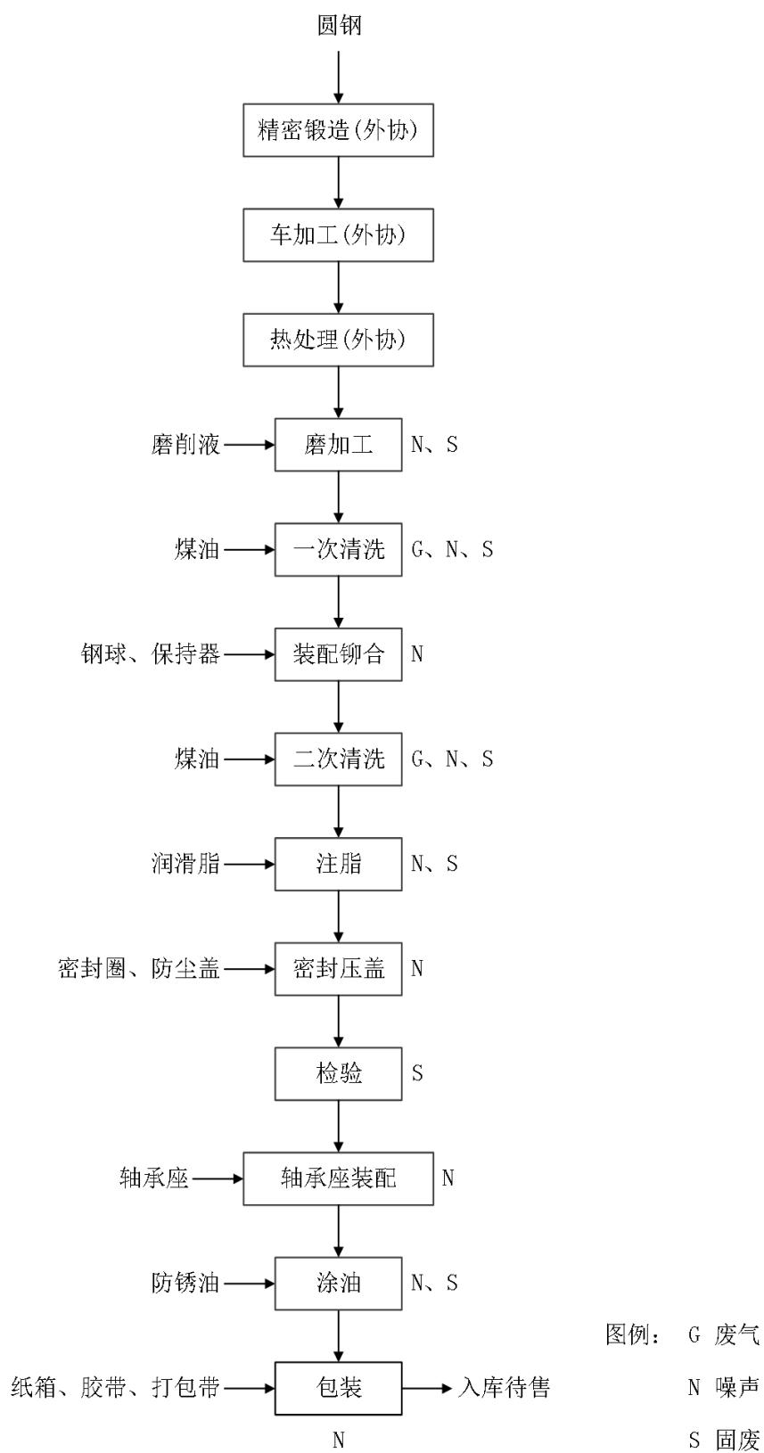
图 2 生产工艺流程及排污节点图
